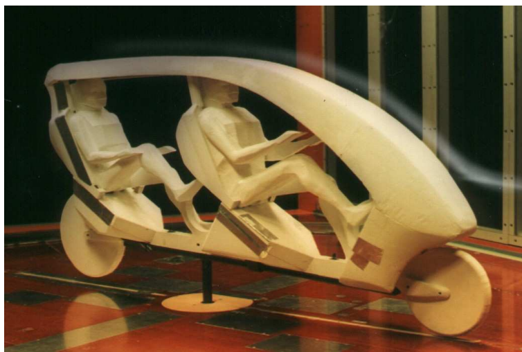
Abbildung 1.5: Ein Modell des Läufers im Windkanal
